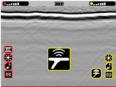
Compensación malo: aparecen franjas horizontales en la imagen del GPR cuando el detector está levantado.
